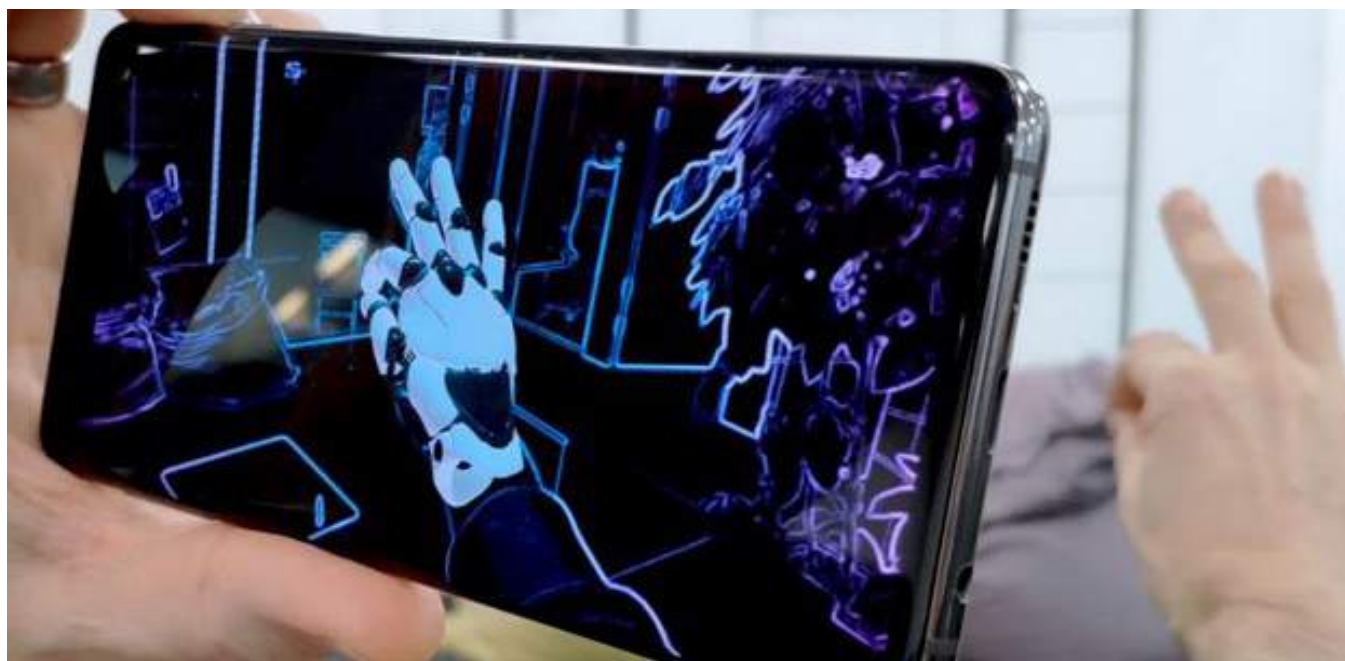
Skeleton 3D hand tracking med en vanlig RGB-kamera ( länk till video )
